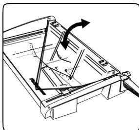
Safecut™ pārsegs salokāms transportēšanai un uzglabāšanai, tas arī nofiksē rokturi apakšējā stāvoklī, lai izvairītos no savainojumiem. Atlocītā veidā SafeCut™ pārsegs vada nazi / asmens sviru un novērš lietotāja savainojumus griešanas laikā. Aizliegts ievietot pirkstus zem giljotīnas naža vai pieskarties asmenim.
